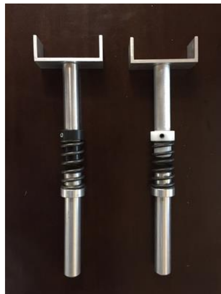
SH2 クラスのライフル支持スタンド(左(黒いパーツ)が強いスプリング(b)、右(白いパーツ)が弱いスプリング(a)のスタンド)
